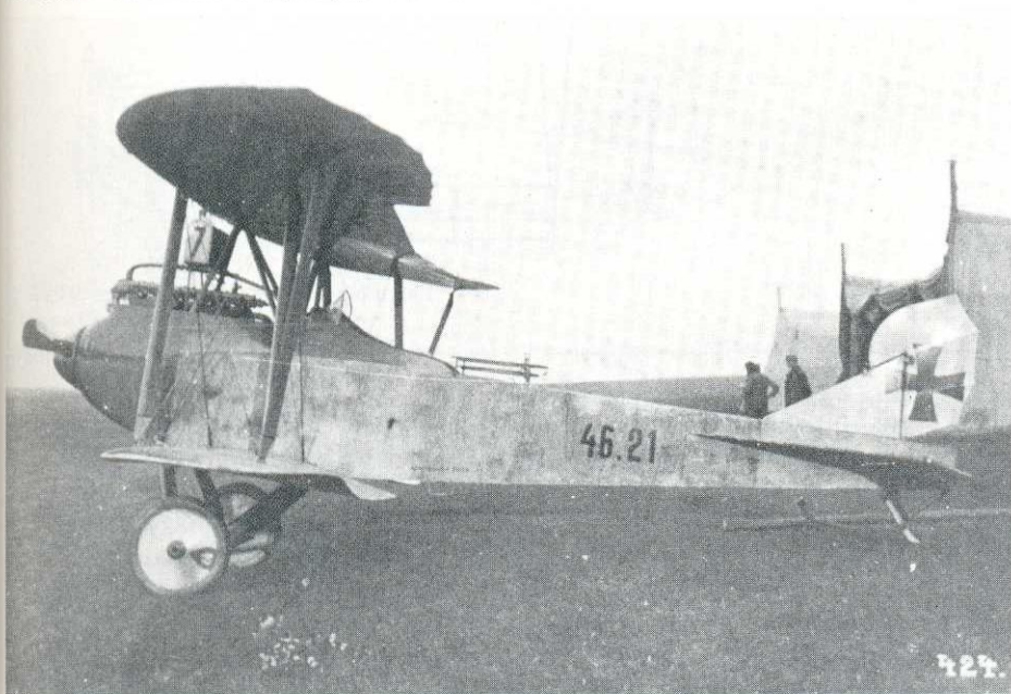
Lloyd C V típusú, 46-os sorozatú felderítő repülőgép, amely Melczer Tibor terve szerint rétegeslemez borítású szárnyal épült 1917-től
