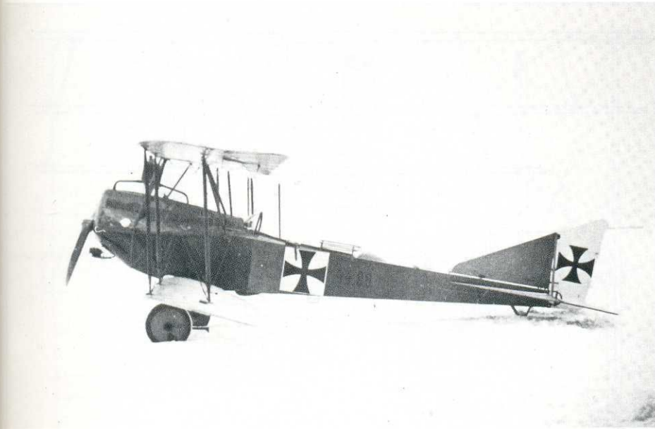
A Lloyd 44-es sorozat felderítő repülőgépei már kevesebb merevítővel és később rétegeslemez borítású szárnyal is repültek
